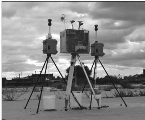
Los monitores miden las concentraciones de polvo y cromo hexavalente.
